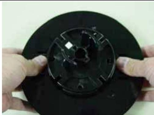
9. Retorne a bobina à unidade principal da impressora. A bobina de papel com o disco vermelho deve ser colocada no lado esquerdo (o rodízio tem cor vermelha na unidade principal) e a bobina de papel com o rodízio branco deve ser colocada no lado direito (o rodízio tem cor branca).
