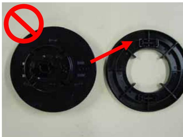
7. Coloque os espaçadores na parte interna da bobina.
