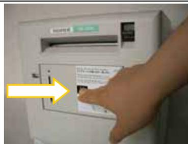
2. A caixa de aparas é ejetada ligeiramente. Segure a caixa de aparas com sua mão segurando pela parte superior e retire-a.
